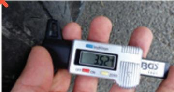
Usure de plus de 50% (c'est-à-dire profondeur du pneu en fond de structure inférieure à 4 mm), pneus ne répondant pas aux spécifications constructeur, usure anormale, entailles, déchirures, corps étrangers sur les flancs, réparation nécessaire. La roue de secours doit être présente et en bon état.
