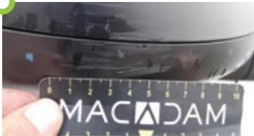
Rétroviseur : Rayures de moins de 2 mm de profondeur et moins de 10 cm de longueur, ou pouvant être éliminées par lustrage
