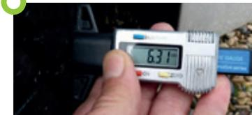
Usure du pneu inférieure ou égale à 50 % (profondeur d'au moins 4 mm en fond de structure).
