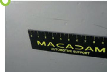
Rayures superficielles pouvant être éliminées par polissage ou sans rouille d'une longueur maximale de 5 cm (avec un maximum de 2 rayures par élément).
