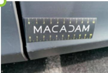
Protections latérales et bas de caisse : rayures pouvant être éliminées par lustrage, ou maximum 3 rayures de moins de 5 cm de longueur et 1 mm de largeur, sans arrachement de peinture (si élément peint et par élément).
