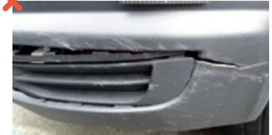
Fêlure, déformation, arrachement de matière, plaque non lisible... Déformation nécessitant plus de 4h de main d'oeuvre, fissures, cassures, éléments dangereux ou non conformes aux règles de circulation. Traces de résidus ne pouvant être éliminées par lustrage.
