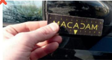
Rétroviseurs latéraux cassés ou manquants (miroir ou corps), arrachés ou mal fixés. Rétroviseurs avec plus de 3 rayures ou rayure de plus de 5 cm, ne pouvant être éliminée par lustrage.
