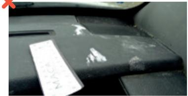
Trous, déchirures, nettoyage nécessaire (salissures, odeurs persistantes,...). Dégâts sur sellerie ou ciel de toit. Plus de 3 dommages ou dommages supérieurs à 3 cm sur tapis. Plusieurs rayures ou de plus de 10 cm, sur garnitures ou tableau de bord. Volant griffé ou décousu.
