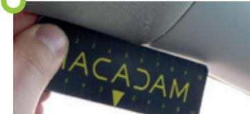
Maximum 3 dommages non perforants de moins de 3 cm sur les tapis (par élément). Rayures superficielles et inférieures à 10 cm sur les garnitures de coffre.
