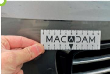
Dégâts pouvant être éliminés par lustrage. Moins de 3 rayures de moins de 15 cm x 2 cm et de moins d'1 mm de profondeur, sans arrachement de matière (par élément).
