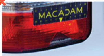
Toute surface vitrée cassée, fêlée. Feux présentant des problèmes d'étanchéité, rayure sur un optique à hauteur du faisceau lumineux ou de plus de 1 mm de profondeur. 2 pattes d'optique cassées ou plus, choc.
