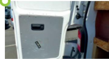
Bosses de moins de 10cm sans déformation de l'élément. 2 garnitures (protections bois) maximum enfoncées. Salissure ou moisissure pouvant être éliminé par un nettoyage haute pression. Rouille légère (maximum 3 points de rouille).
