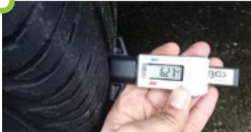
Usure inférieure ou égale à 50%. (profondeur d'au moins 4 mm en fond de structure).
