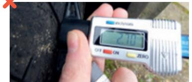
Usure de plus de 50 % (c'est-à-dire profondeur du pneu en fond de structure inférieure à 4 mm), pneus ne répondant pas aux spécifications constructeur, usure anormale, entailles, déchirures, corps étrangers sur les flancs, réparation nécessaire.
