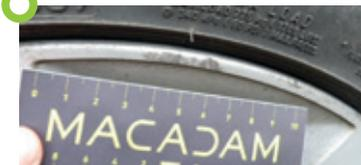
2 dommages maximum sur la même jante de moins de 10 cm sur le bord et 3 cm sur le corps.
