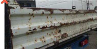
Rouille avancée, plus de 2 dommages de plus de 10 cm par élément, traces de résidus ne pouvant être éliminées au lustrage. Dommages altérant la sécurité, l'utilisation ou l'étanchéité de l'aménagement ou du véhicule. Mécanisme défaillant. Dommages dont la réparation nécessite plus de 4h de main d'oeuvre.
